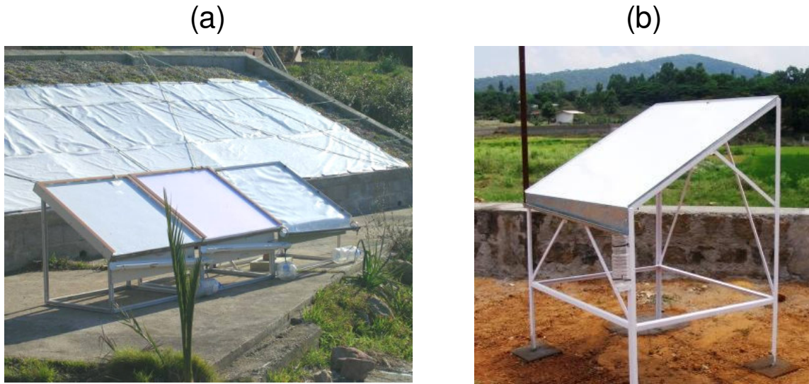
Fig. III.1. (a) Trois condenseurs standard sur le site d'Ajaccio (Université de Corse). De gauche à droite : peinture, Polycarbonate et Film « OPUR ». (b) détail du condenseur tôle + nouvelle peinture radiative sur le site de Yellagiri Hills (Tamil Nadu, Inde). (Photo O. Clus).
