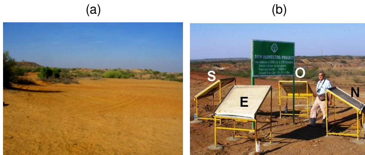
Fig. III.15. (a) Vue d'ensemble d'un paysage typique du Kutch (entre Nalia et Mata-Namad, sur la route joignant Panandhro à Kothara). (b) vue des quatre condenseurs standard de 1 m 2 (type OPUR) faisant face aux quatre directions cardinales sur le site de Panandhro (photo O. Clus).
