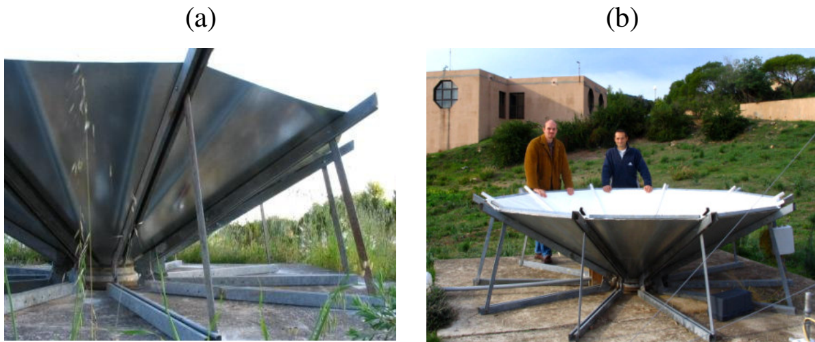
Fig. II.16. (a) détail de l'armature du condenseur conique. (b) vue d'ensemble.
