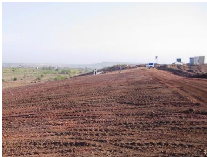
Fig.IV.15. Vue d'ensemble latérale du site expérimental présentant une pente de 40 m de long pour une inclinaison de 15°.
