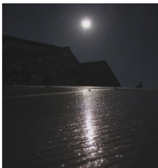
Fig. IV.8. Événement de rosée courant à Biševo : (a) condensation nocturne et écoulement continu dès 20 h sur le toit ; (b) mesure du pH pour environ 4,5 L de rosée condensée sur 15,1 m 2 dans un bidon de 5 L le 19 avril 2005. (photo O. Clus)
