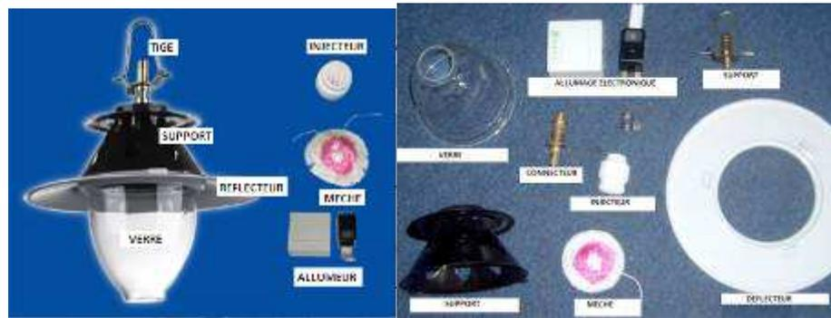
Les lampes biogaz sont montées selon les instructions fournies. La lampe est allumée avec l'allumage électronique ou une allumette. Allumer la vanne à 1/3 et approcher l'allumette de la chaussette. Une fois allumée, augmenter la puissance en ajustant l'ouverture de la vanne.
