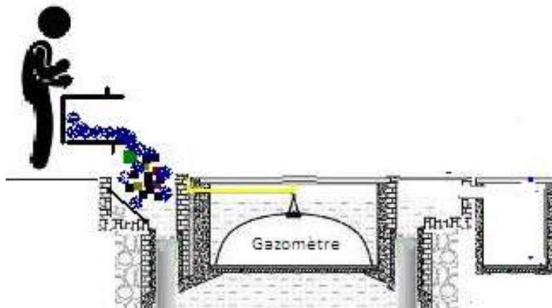
Lorsque le liquide est introduit, une quantité équivalente ressort et va dans le bac de stockage du liquide.
