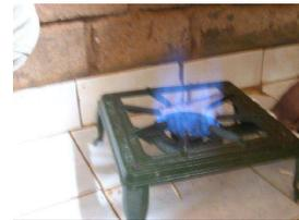
En utilisation carburant 1 m<sup>3</sup> de biogaz = 0,6 l de gasoil ou essence
