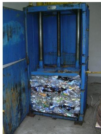
Photo 3: Presse simple pour bouteilles PET telle qu'utilisée en Biélorussie (Sophie van den Berg)
