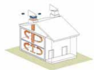
Ventilation naturelle à récupération de chaleur
