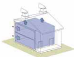
Construction hermétique avec ventilation naturelle contrôlée
