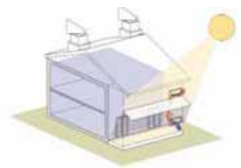
Avancée de toiture et store pour protéger la maison des étés trop chauds
