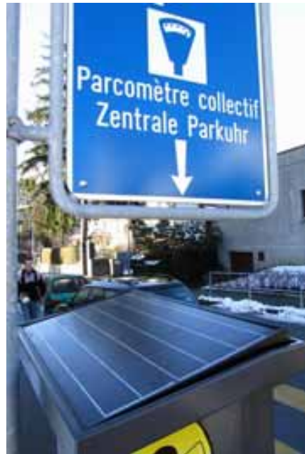
Illustrations 1 et 2: Des parcomètres autonomes grâce au photovoltaïque. Le modèle le plus répandu à Fribourg, avec un gros plan sur le module solaire intégré. Source: M. Gutschner, Fribourg.
