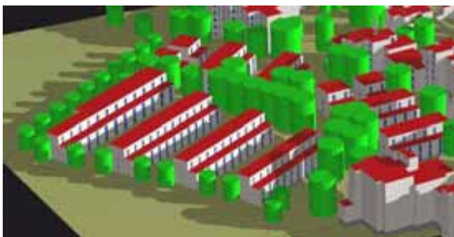
Illustrations 113 et 114: Exemple d'optimisation pour une conception efficace du point de vue énergétique et solaire: plus de lumière et moins de consommation d'énergie. La situation topographique se caractérise par une pente d'environ 6 % en direction de l'est et, au sud et à l'est, des constructions de 3 à 8 étages. L'approche retenue pour l'optimisation (à droite) inclut des distances plus élevées entre les bâtiments, une profondeur admise augmentée à 12 m (qui permet de réduire le nombre de barres de quatre à trois) ainsi qu'une optimisation de la hauteur des bâtiments. Résultat: pour une surface habitable identique,
