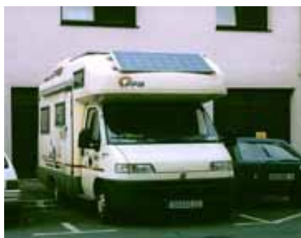
Illustrations 13 à 15: Utilisation avec des véhicules. Autocaravane à Bamberg (Allemagne), poste de police mobile pour les quartiers de Lausanne avec installation photovoltaïque ne provoquant ni bruit ni émissions pour alimenter les appareils embarqués, ainsi que station de recharge mobile pour vélos et scooters électriques. Sources: M. Gutschner, Fribourg; SIL; Newride.
