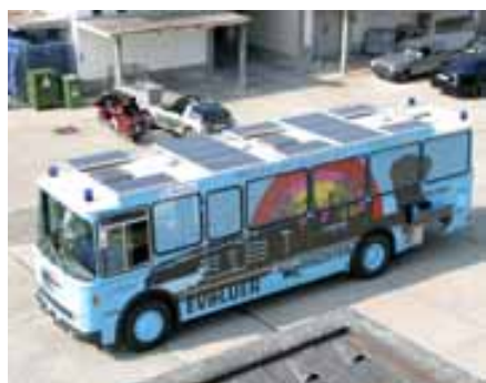
Illustrations 13 à 15: Utilisation avec des véhicules. Autocaravane à Bamberg (Allemagne), poste de police mobile pour les quartiers de Lausanne avec installation photovoltaïque ne provoquant ni bruit ni émissions pour alimenter les appareils embarqués, ainsi que station de recharge mobile pour vélos et scooters électriques. Sources: M. Gutschner, Fribourg; SIL; Newride.
