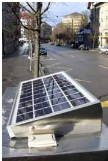
Illustrations 4 et 5: Automates à titres de transport. Les entreprises de transports de Genève et de Fribourg utilisent des automates alimentés en courant photovoltaïque. Gros plan: l'inclinaison du module facilite l'écoulement de l'eau (et de la neige), maintenant la surface propre. Source: M. Gutschner, Fribourg.
