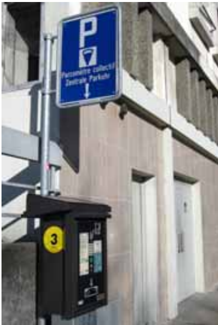
Illustrations 1 et 2: Des parcomètres autonomes grâce au photovoltaïque. Le modèle le plus répandu à Fribourg, avec un gros plan sur le module solaire intégré. Source: M. Gutschner, Fribourg.
